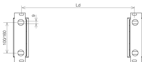
Schéma ukotvení k podlaze
